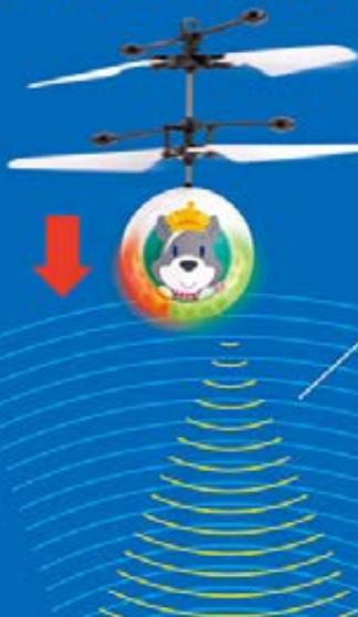
若下方沒有物件，紅外線則到達地板才反射，因移動距離變遠，有較多時間減弱。感應器探測到較弱的紅外線，旋翼就會隨之減慢轉速，使飛行器下降。
