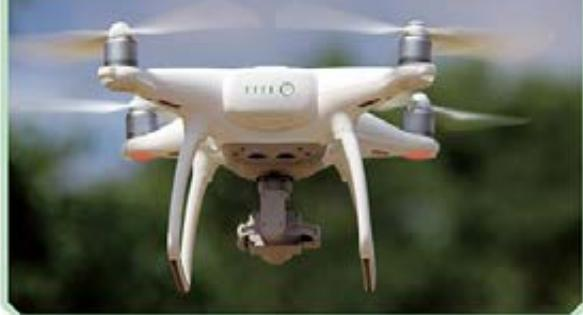
▲旋翼無人機可在低空停留，適合做監測或拍攝的工作。定翼無人機也可進行同類工作，但要在較高空飛行。
