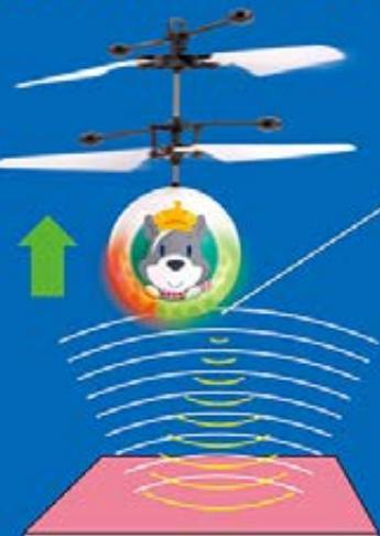
發射器向下發射紅外線。這些紅外線有一個特定的頻率，跟環境中的其他紅外線不同，以免感應器混淆。
